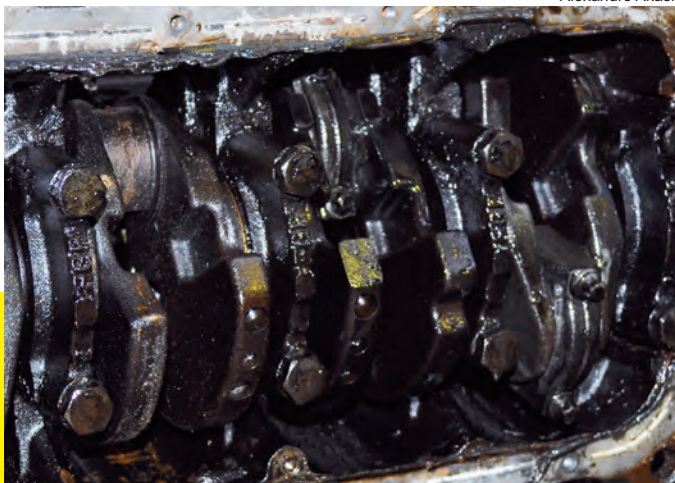
Borra ocorre pela falta de troca de óleo e pode fundir o motor
