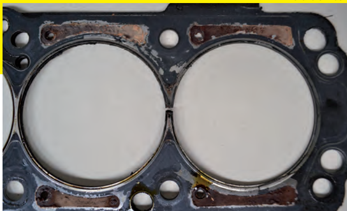
Quando queima, a junta do cabeçote deixa passar líquido de arrefecimento
