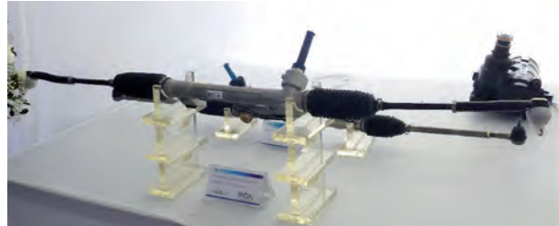
Caixa de direção sem assistência que equipa o novo subcompacto
