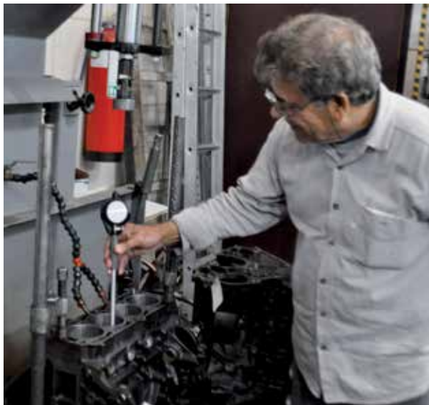
Técnico realiza medição das folgas do cilindro do motor
