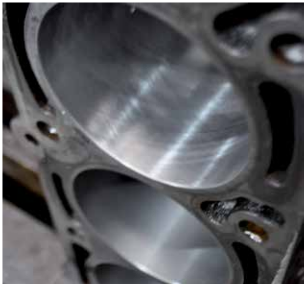
Diferença entre o cilindro brunido em X (em cima) para o bruto, liso
