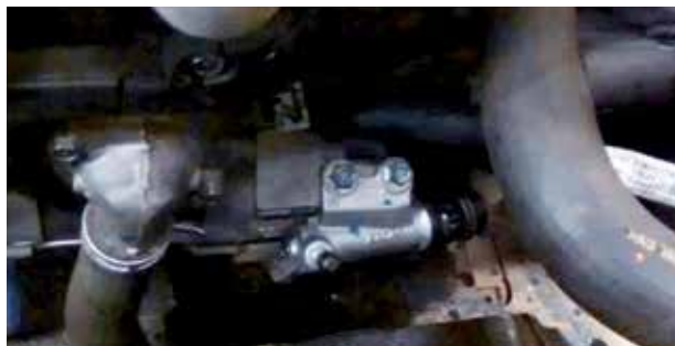
O atuador hidráulico é externo e apresentou vazamento
