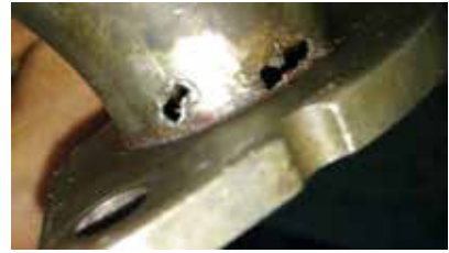
Furos no tubo de arrefecimento
