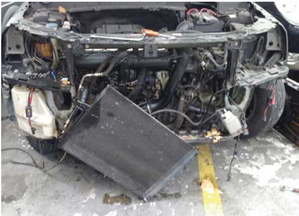
Para realizar manutenção no sistema de arrefecimento é preciso desmontar toda a frente do veículo
