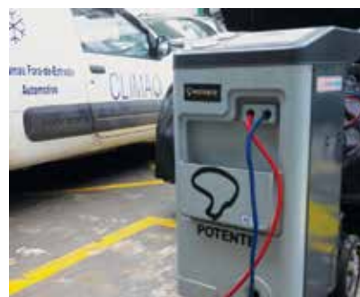
Equipamento de troca de gás do AC
