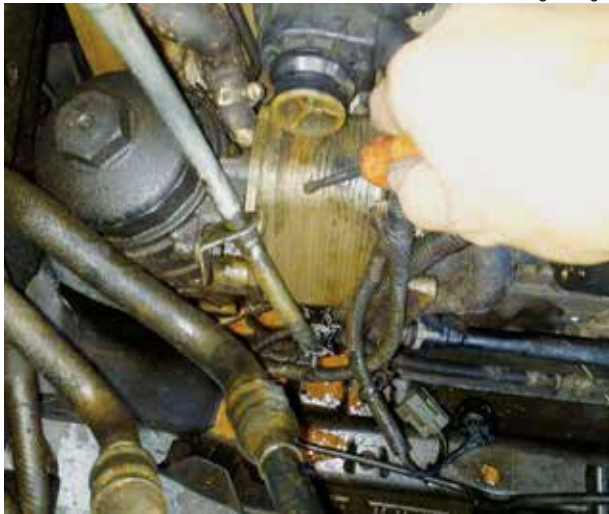
Defeito no trocador de calor do motor; peça custa mais de R$ 2.000
