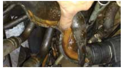
Mangueira do radiador estava toda rasgada
