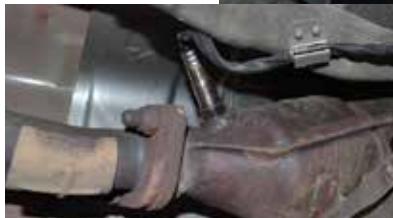
Após realizados diversos testes, causa provável do defeito estava no sensor de oxigênio pós-catalizador
